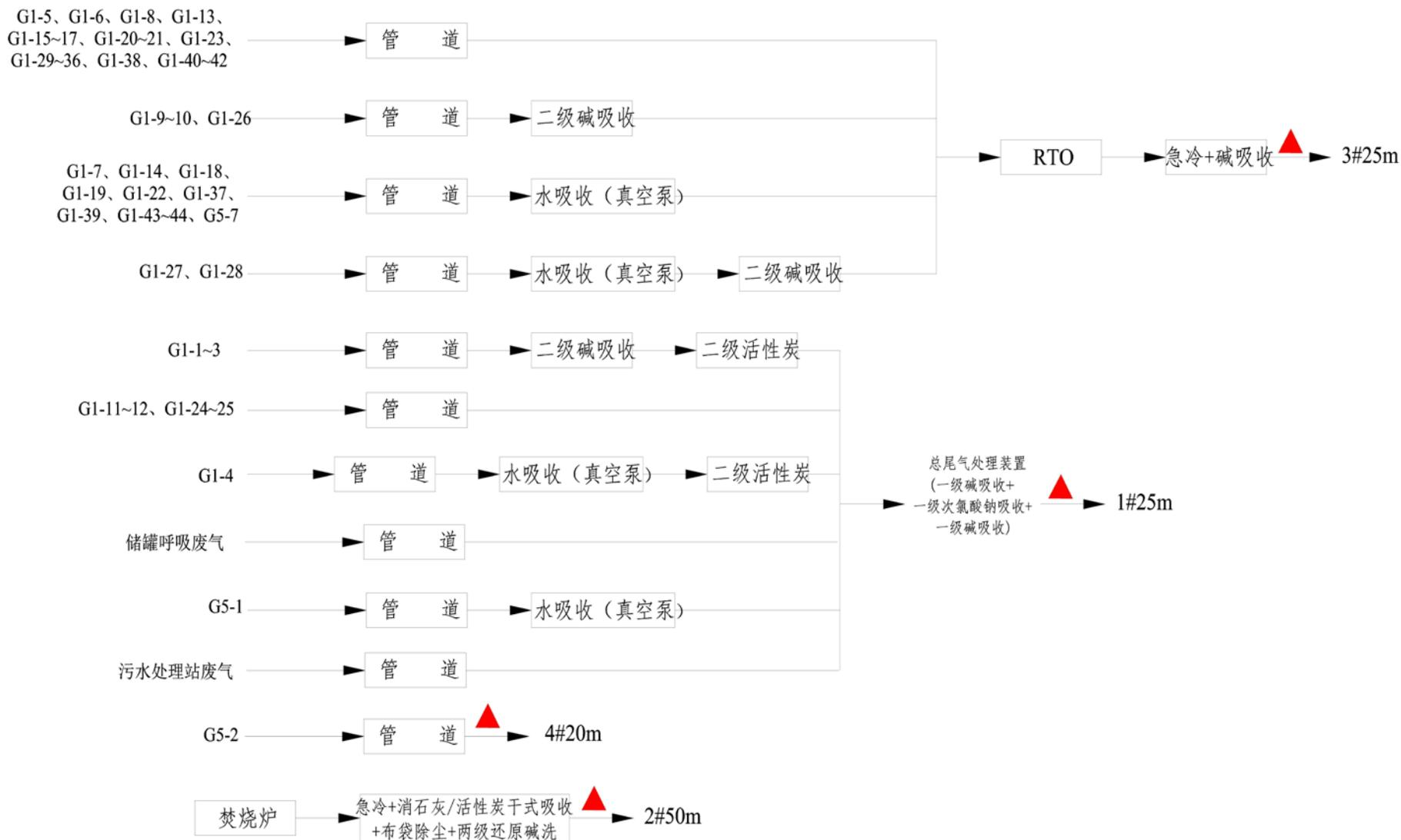
图 4-2 项目废气收集处理工艺示意图
